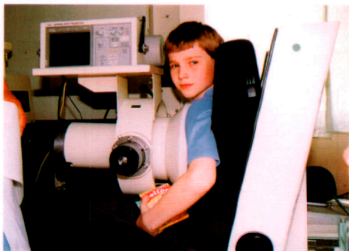
2. アロカ車載型放射線ホールボディカウンター (線量計) WBC-100 型
