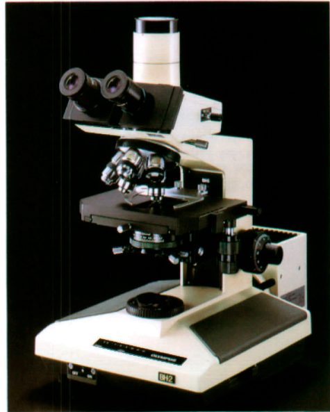
Рисунок 8. Микроскоп "Олимпус": 1) Бинокулярный микроскоп BHS-112 2) Дискуссионный микроскоп BHS-112+ BH2-DO-1 3) Триокулярный микроскоп BHS-312 4) Фильмирующее устройство PM10- 35ADS-2
