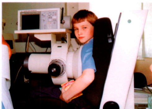
Рисунок 2. Устанавливаемый на передвижной лаборатории счетчик суммарной дозы радиоактивности для всего организма «Алока» (счетчик дозы WBC-100).
